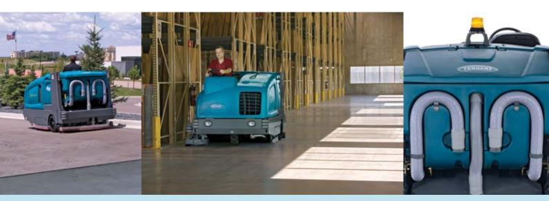
La barredora-restregadora completamente integrada M30 está diseñada para una limpieza industrial confiable y permite restregar, barrer o hacer las dos cosas al mismo tiempo.
